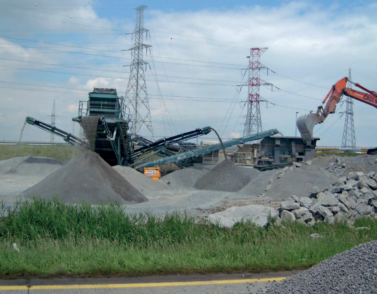
Installatie voor vergruizen en zeven bij de N49, Zwijndrecht, België, © AWW, Vlaams Agentschap Wegen & Verkeer
