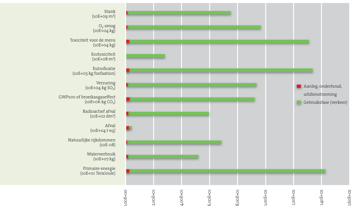
Figuur 2 : Impact over de levensduur van een weg in platenbeton inclusief verkeer voor verschillende milieu-indicatoren
